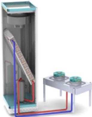
Внутренний блок кондиционера соединяется фреонопроводами с наружным блоком. Избытки тепла из охлаждаемого помещения передаются с помощью фреонопроводов к конденсаторному блоку и рассеиваются во внешнюю среду. Конденсаторы доступны в стандартной версии и с низким уровнем шума.
