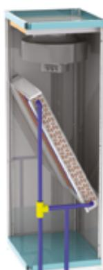
Кондиционер является безкомпрессорным и подключается к трубопроводам с охлажденной (чиллерной) водой. Избытки тепла из охлаждаемого помещения передаются через теплообменник охлажденной воде, которая, в свою очередь, охлаждается чиллером.
